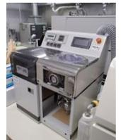
2-4.MSE表面強度評価装置 (手動機)
