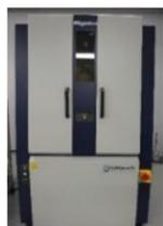
3-19. 試料水平型多目的X線解析装置(Ultima IV)
