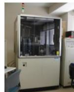
3-2. イメージングプレート単結晶X線構造解析装置
