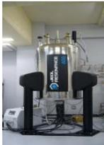
2-3. 高分解能固体・溶液核磁気共鳴測定装置
