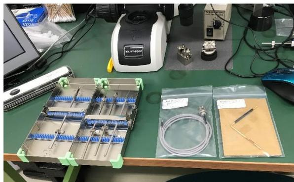
写真：各種先端工具（左側がナイフやプローブ、右側が電極ホルダー）
